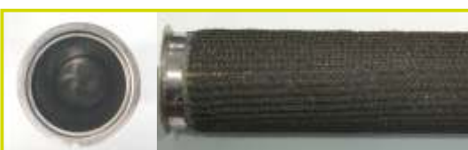
Hengeres kialakítású, acélorost-hálóval borított nemesacél égő. Ellenáll a magas hőmérsékletnek. Rövid lángot biztosít a tökéletes égés és a minimális Nox kibocsátás érdekében.
