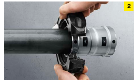
1\frac{1}{2} colos és nagyobb méretű Megapress idomok préseléséhez kizárólag csuklós behúzópofás présgyűrűk használhatók. Kisebb, \frac{3}{8} és 1 col közötti méreteknél préspofa és présgyűrű is rendelkezésre áll csuklós behúzópofával.
