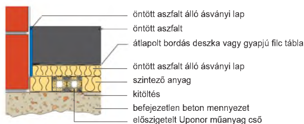
Padlószervezet öntött aszfalttal
